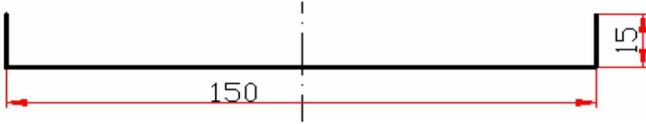
Şekil 1.2: Kenarları bükülmüş sac
