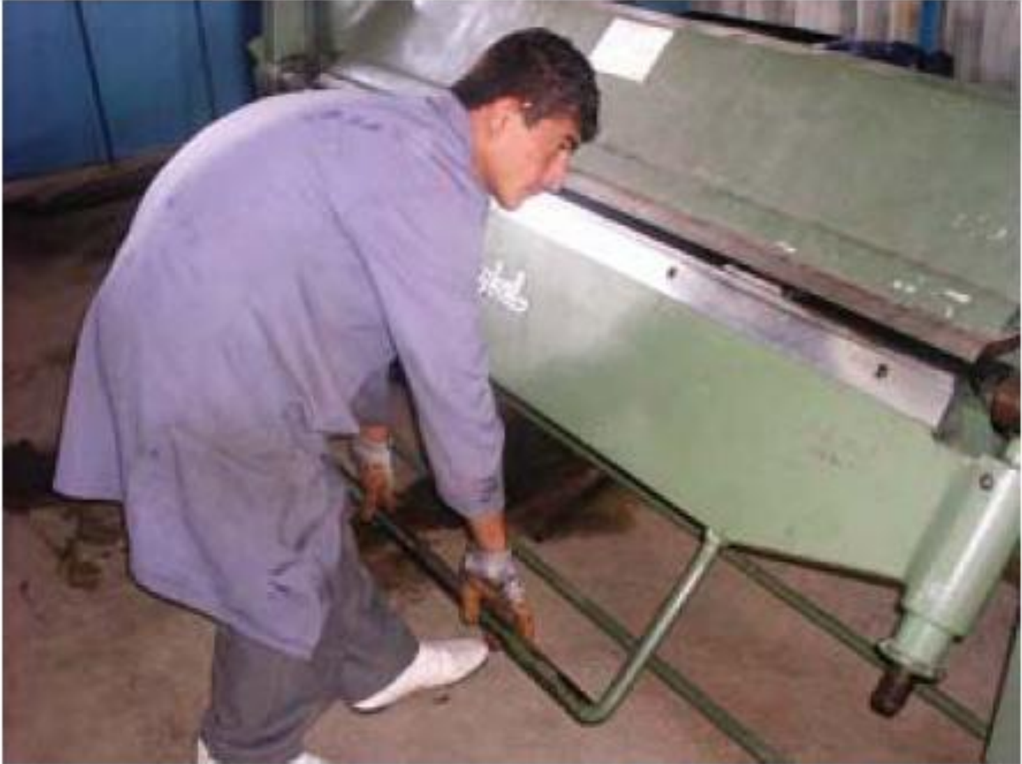
Resim 2.3 Bükme işlemi cakada yapılır
