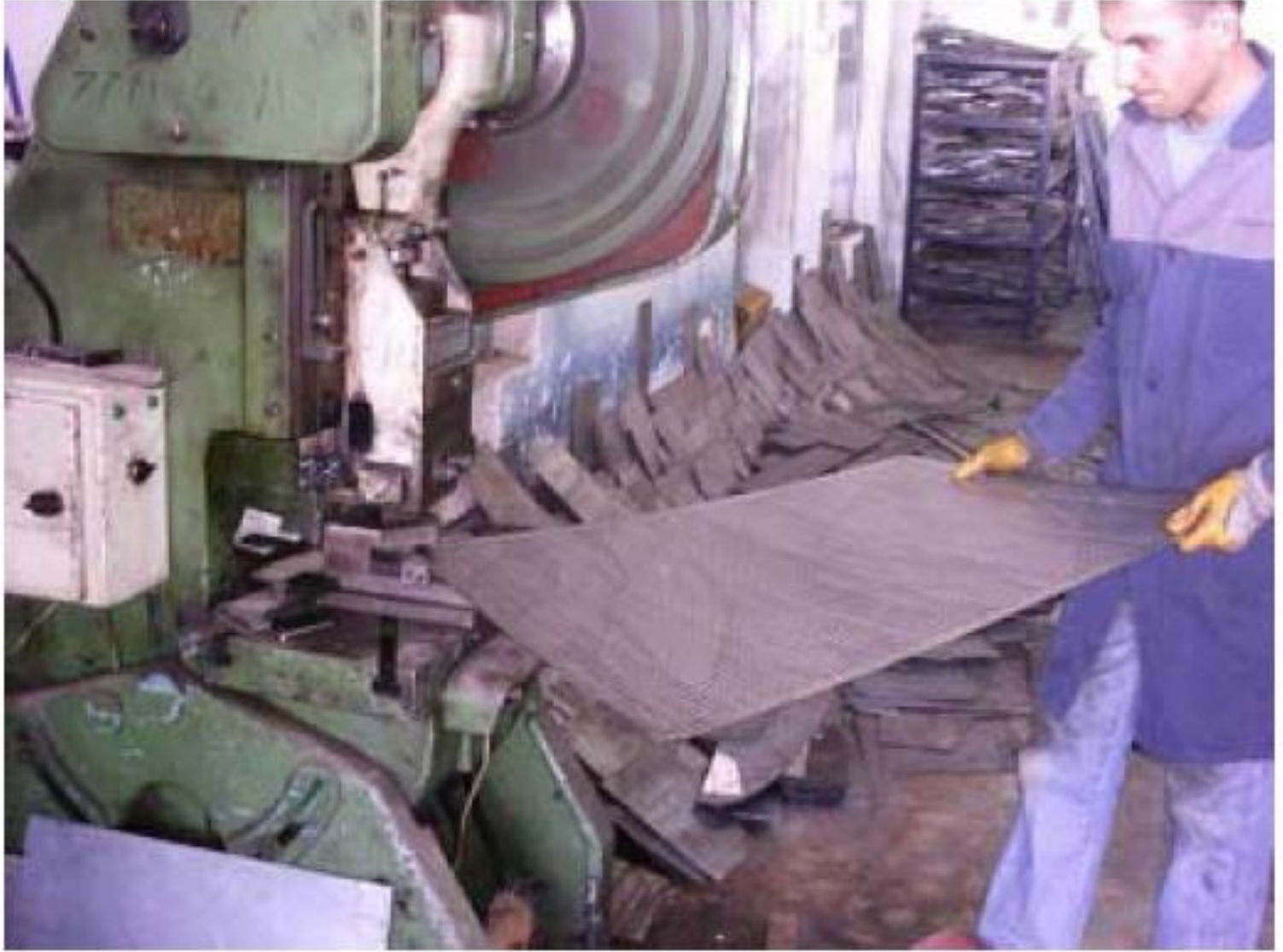
Resim 1.6: Eksantirik preste bir köşe çıkarma işlemi yapılırken görülmektedir.
