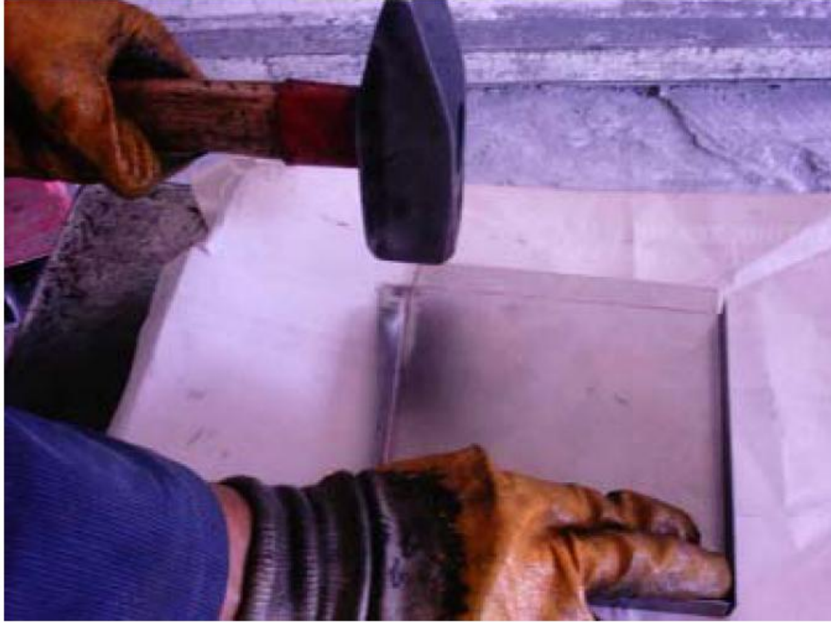
Resim 1.2: Apkantta bükülen sacın düzeltilmesi
