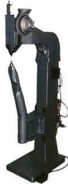
Resim 1.3: Otomatik ve el kumandalı elektro- hidroprnömatik perçin besleme tertibatlı, perçin ayarlı ve göz açma tertibatlı perçinleme makinesi
